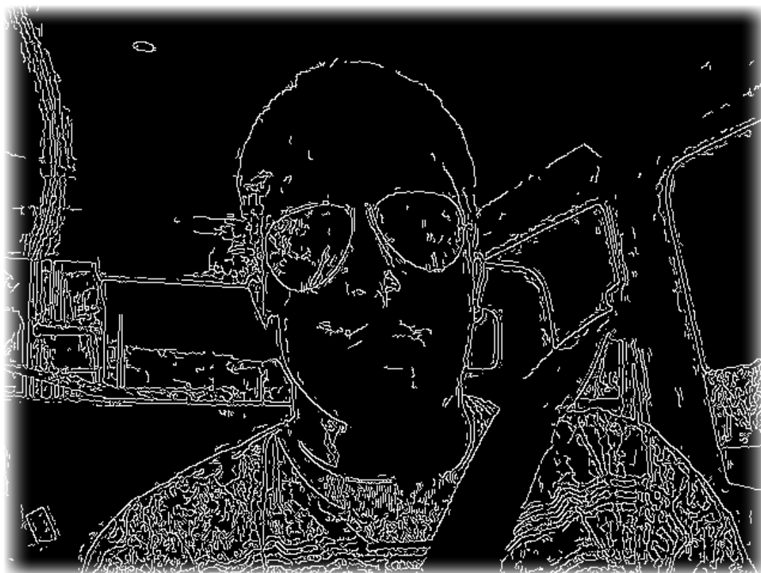
Figura 5.2: Edge Detector. Immagine dopo l'applicazione dell'algoritmo Canny Detector
