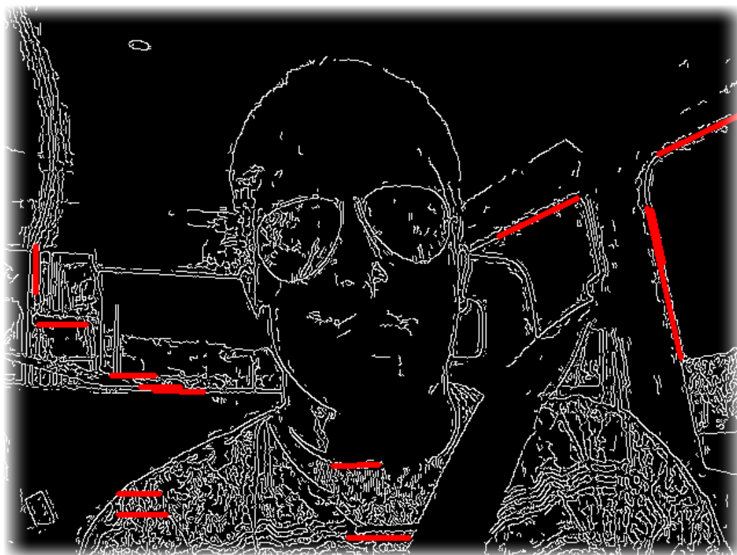
Figura 5.4: Linee di Houg. Risultato dell'applicazione dell'algorithmo alla Figura 5.2.
